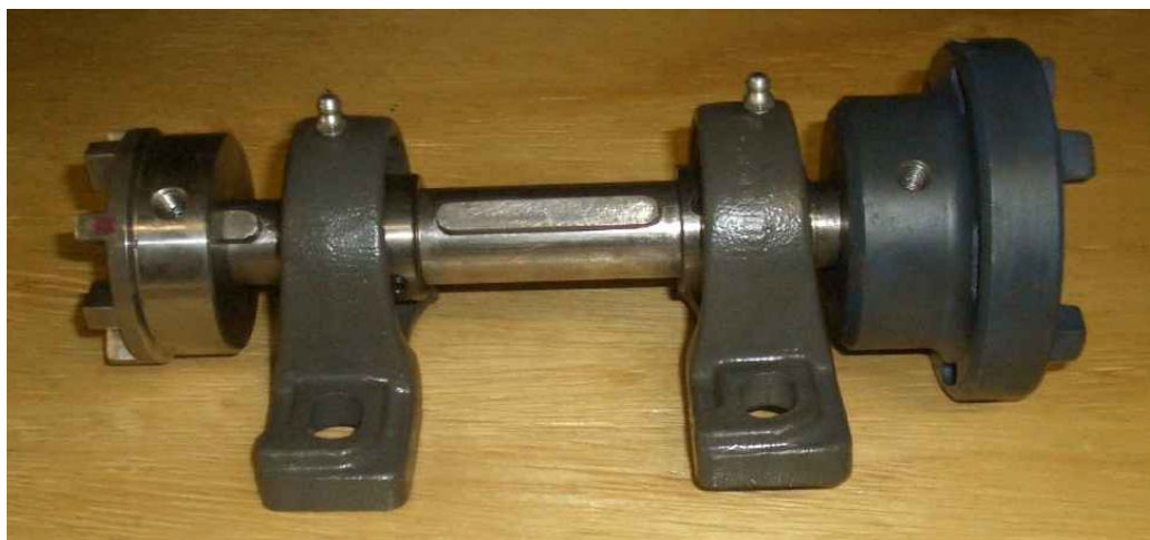
Figura 15 - Eixo projetado com mancais de rolamento e partes dos acoplamentos elásticos
